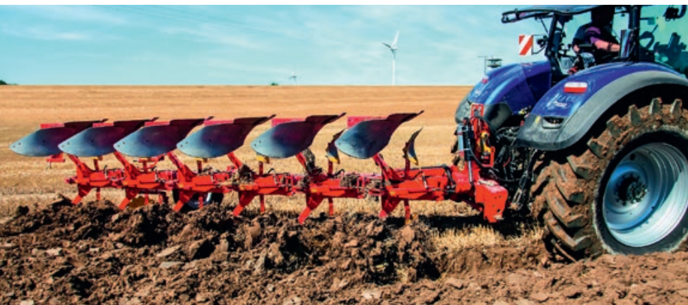
Forgatásos talajműveléshez Pöttinger Servo eke függesztett és félig függesztett kivitelben 3-tól egészen 9 ekefejes változatig
